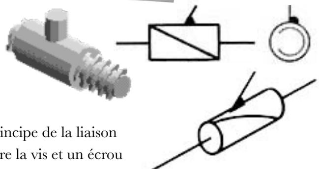
Principe de la liaison entre la vis et un écrou
