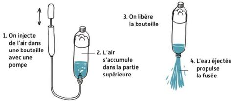
Exemple de principe de fonctionnement d'une fusée à eau.
